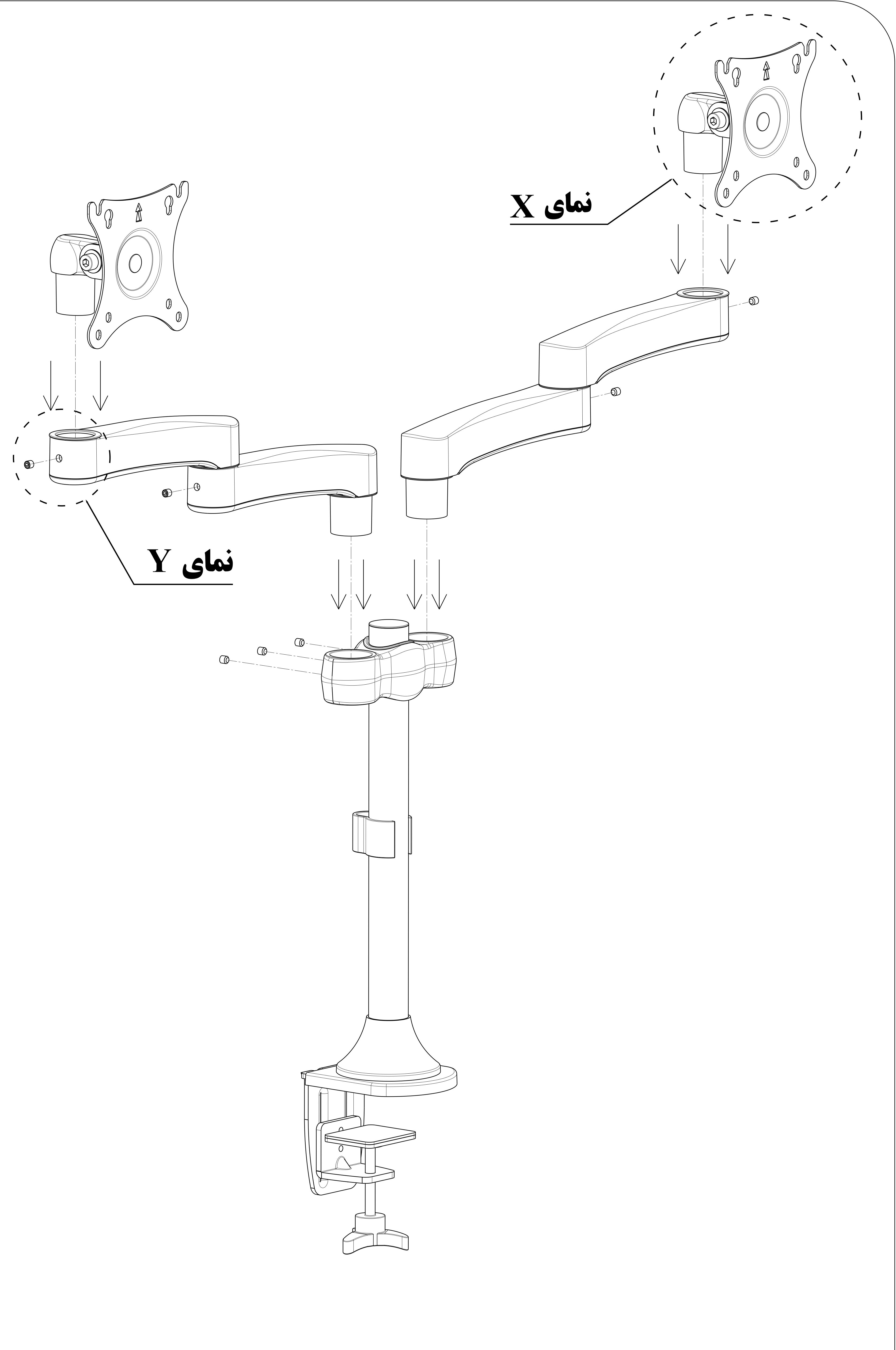
**گام سوم:** مطابق با شکل ۵ و با توجه به سایز سوراخ های پشت مانیتور، چهار عدد پیچ و واشر مناسب از پک ملزومات محصول انتخاب کرده، دو عدد از پیچ ها را همراه با واشر مناسب به دو سوراخ بالایی مانیتور تا چند رزوه ببندید. حال مانیتور را برداشته و پیچ های بسته شده به آن را بر روی قلاب های پلیت فلزی (A) قرار دهید. (نمای W)
